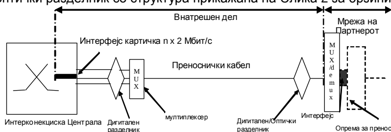
Слика 2. Внатрешен дел за интерфејс од 34 Мбит/с (Е3) или 155 Мбит/с (СТМ-1)
